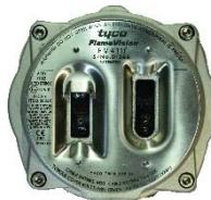
دتکتورهای شعله‌ای تشعشعات الکترومغناطیسی (electromagnetic radiation) ساطع شده از حریق که با سرعت نور حرکت می‌نمایند، را دریافت نموده و به آن پاسخ می‌دهند و با توجه به سرعت بالای انتقال تشعشعات مادون قرمز، این دتکتورها دارای سرعت عمل بسیار بالائی بوده که در نتیجه مناسبترین روش جهت کشف حریق‌های کلاس B می‌باشدند.
